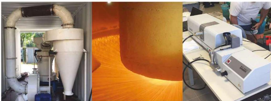
4. Sistema di atomizzazione a secco per ottimizzare la gestione della scoria all'interno degli stabilimenti di produzione, aumentando reattività e migliorando la granulometria per facilitarne la lavorazione presso gli impianti di macinazione;
